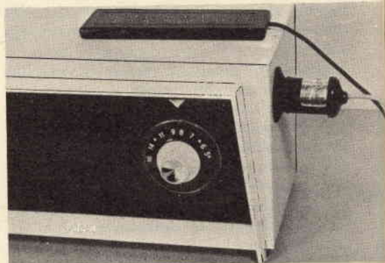
Nella fotografia si vedono due tipi di pick-up. Per captare i segnali di un radiorecettore si pone semplicemente il pick-up nel forte campo induttivo dell'altoparlante o del trasformatore di uscita.
